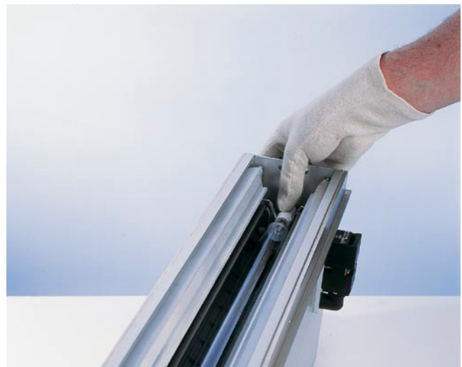
Die UV-Lampe wird eingelegt und rastet durch leichten Druck automatisch ein
